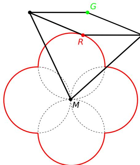
Robin probiert das Gerät an der abgebildeten Figur, bestehend aus vier Kreisbogenabschnitten von Kreisen mit Durchmesser 7 cm, aus. Er fährt bei festgehaltenem Ende  $M$  also mit der Abtastspitze  $R$  die durchgezogene Linie ab, wobei der grüne Stift  $G$  eine Kurve auf das Papier malt.
