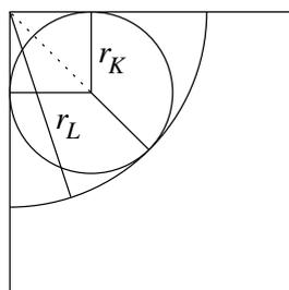
Aus Symmetriegründen berührt die Kugel, wenn sie im Loch steckt, den Viertelkreisbogen des Loches genau auf der Winkelhalbierenden. Daher ist der Radius  $r_L$  des Loches die Summe des Radius der Kugel  $r_K = 5$  cm und des Abstandes des Kugelmittelpunktes von der Ecke. Dieser Abstand ist  $\sqrt{2} \cdot 5$  cm, also ist  $r_L = 5(1 + \sqrt{2})$  cm  $\approx 12,071$  cm.
